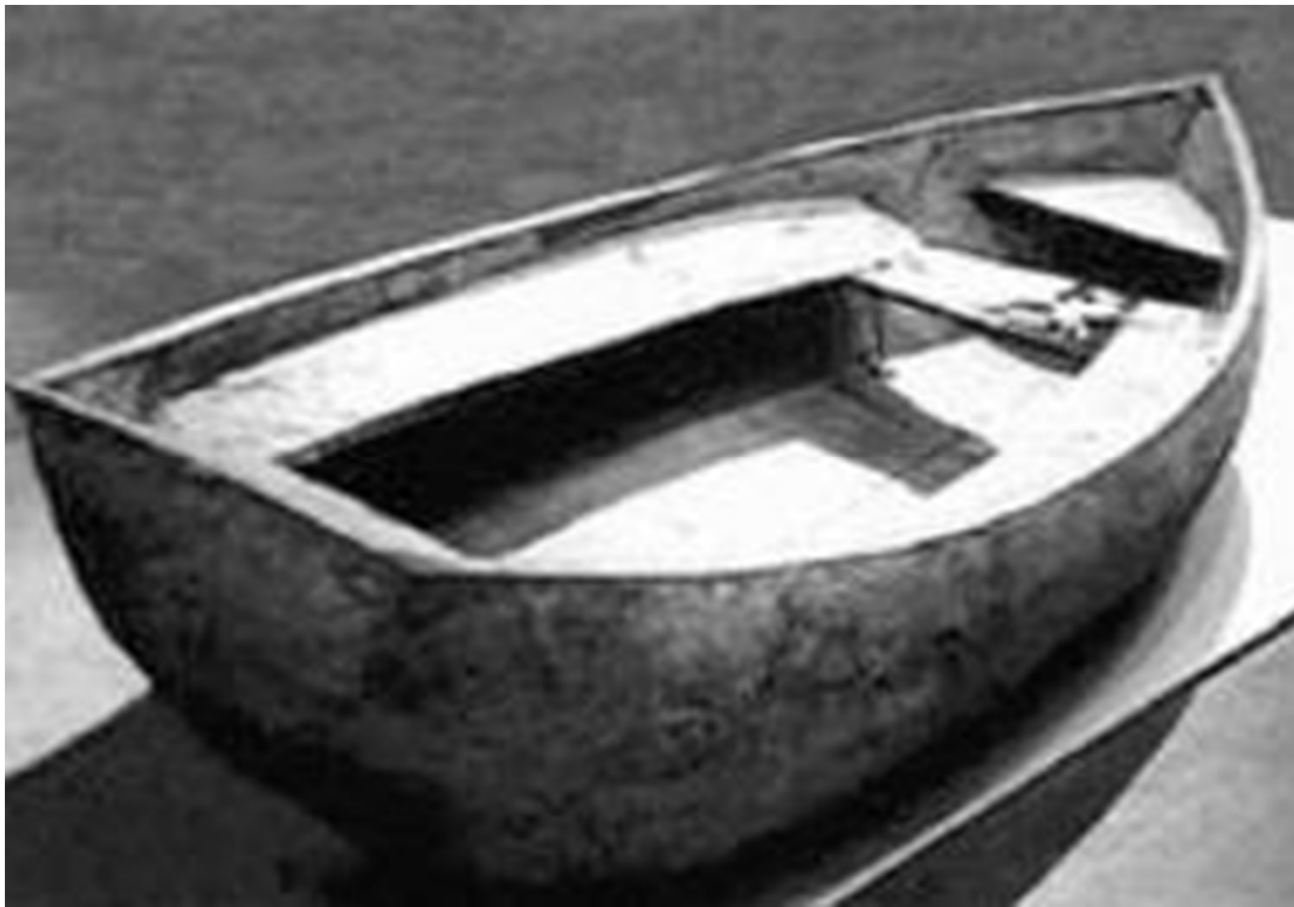
Vasbeton csónak - Lambot
