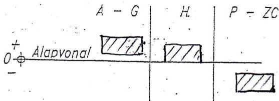
9. Rajzolja le a - belméretekre (lyukakra) vonatkozó - megadott betűkkel jelölt szabványos alapeltérések tűrésmezőinek az alapvonalhoz viszonyított helyzetét!
