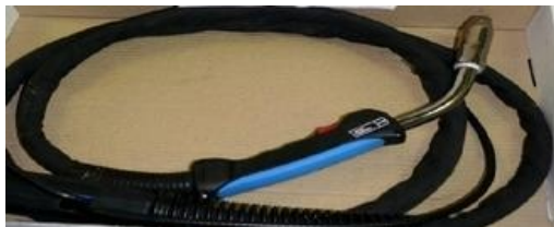
3.8. ábra. Hegesztőpisztoly készlet lánghegesztéshez, CO 2 védőgázas hegesztőpisztoly
