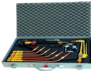
3.8. ábra. Hegesztőpisztoly készlet lánghegesztéshez, CO 2 védőgázas hegesztőpisztoly
