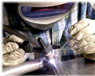
3.9. ábra. Argon védőgázas wolframelektrodás ívhegesztés AWI munkaadománya és művelete
