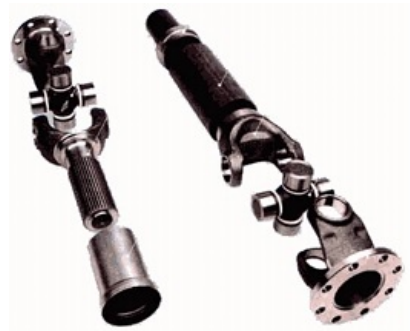
5.15. ábra. Szétszerelt kardánkapcsoló
