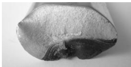
4.17. ábra. Fáradt törés
