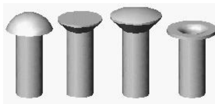
3.2. ábra. Szegecskék térhatású ábrája
