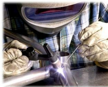
3.9. ábra. Argon védőgázos wolframelektrodás ívhegesztés AWI munkaadománya és művelete
