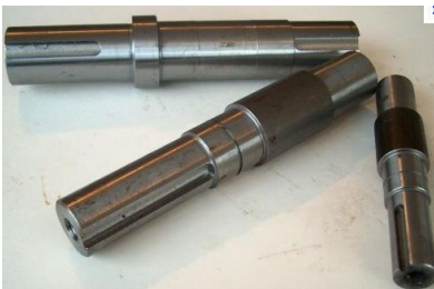
4.2. ábra. Egyenes középvonalú tengelyek, forgattyús tengely
