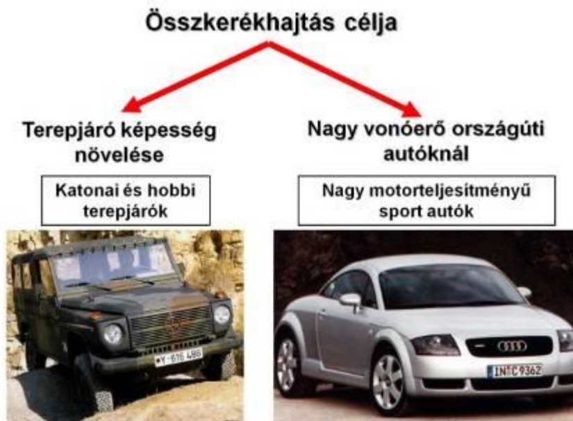
1.2.9. ábra: Az összkerékajhajtás alkalmazásának célja [5,1]
