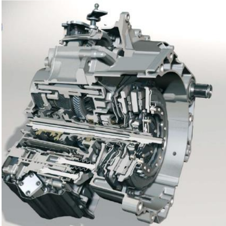
3.3.2. ábra Száraz tengelykapcsolóval rendelkező DSG sebességváltó [3,3]
