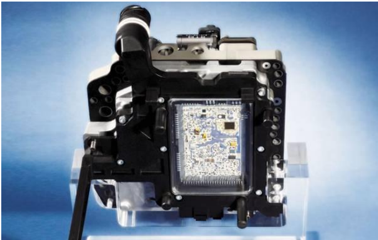
3.2.3. ábra Az elektronikus rendszer (hardver) a mechatronikai egységre szerelve. [3,2]
