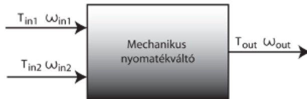
6.4.9. ábra: Nyomatékösszegzés az elméletben
