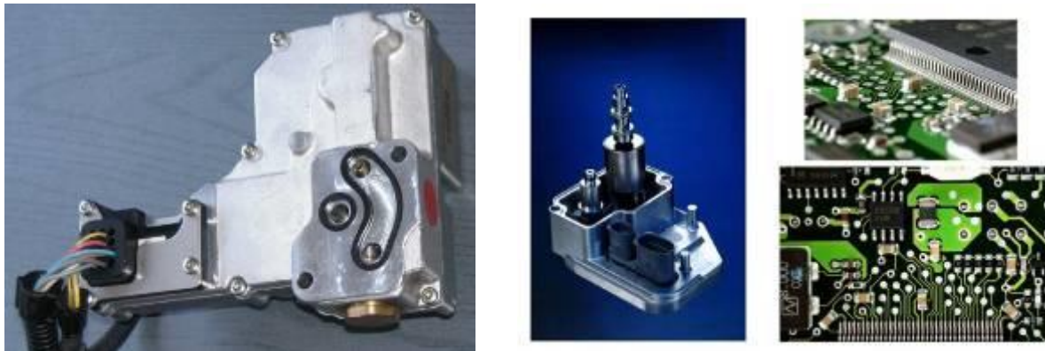
1.3.18. ábra: Haldex LSC hajtómű egységről elszertelt elektronika a szabályozó tolattyúval és részletei [5,3]
