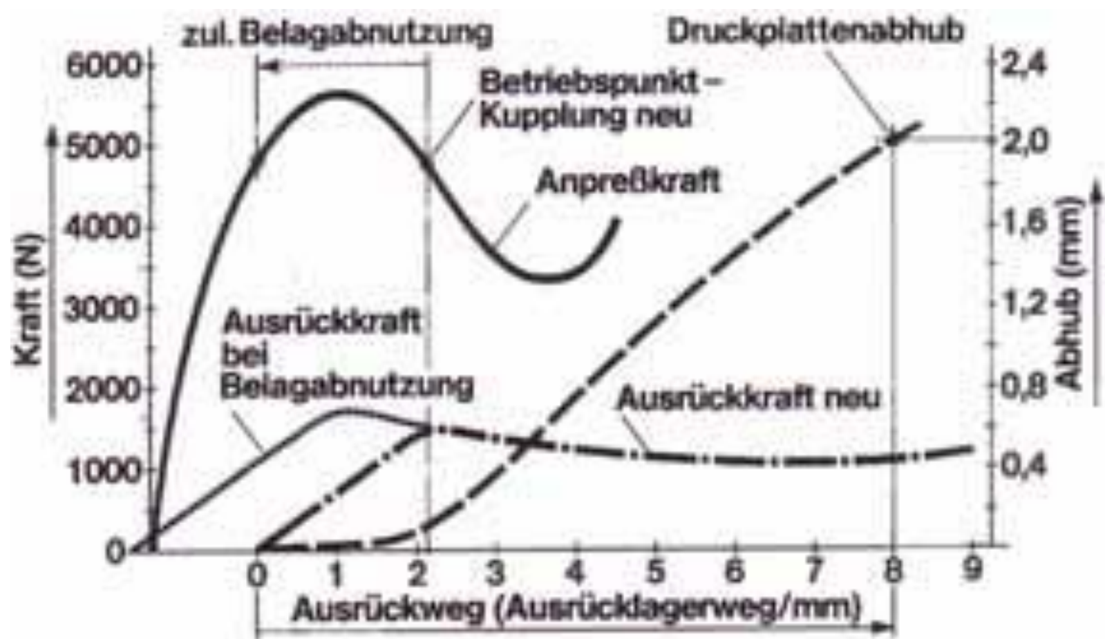
Kupplungskennlinien (Beispiel)
