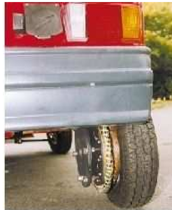
3 kW-os 10pólusú háromfázisú kísérleti motor a Line-Car járműben
