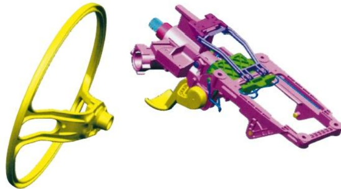
4. ábra: Mg-ötvözetből készült kormánykerék és kormányoszlop (Fig_3_4.jpg)
