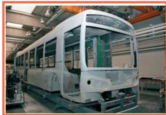
12. ábra. Üvegszálás polimer kompozit busz karosszéria
