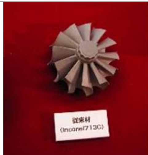
11. ábra: Nikkel szuperötvözetből készített turbófeltöltő. Az anyag: Inconel 713C, összetétele: Ni-2Nb-12.5Cr-4.2Mo-0.8Ti-6.1Al-0.12C-0.012B-0.1Zr
