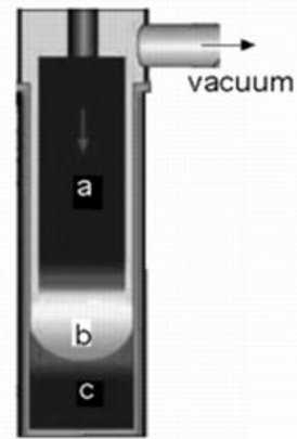
12. ábra: Vákuumos átolvasztás elvi rajza.
